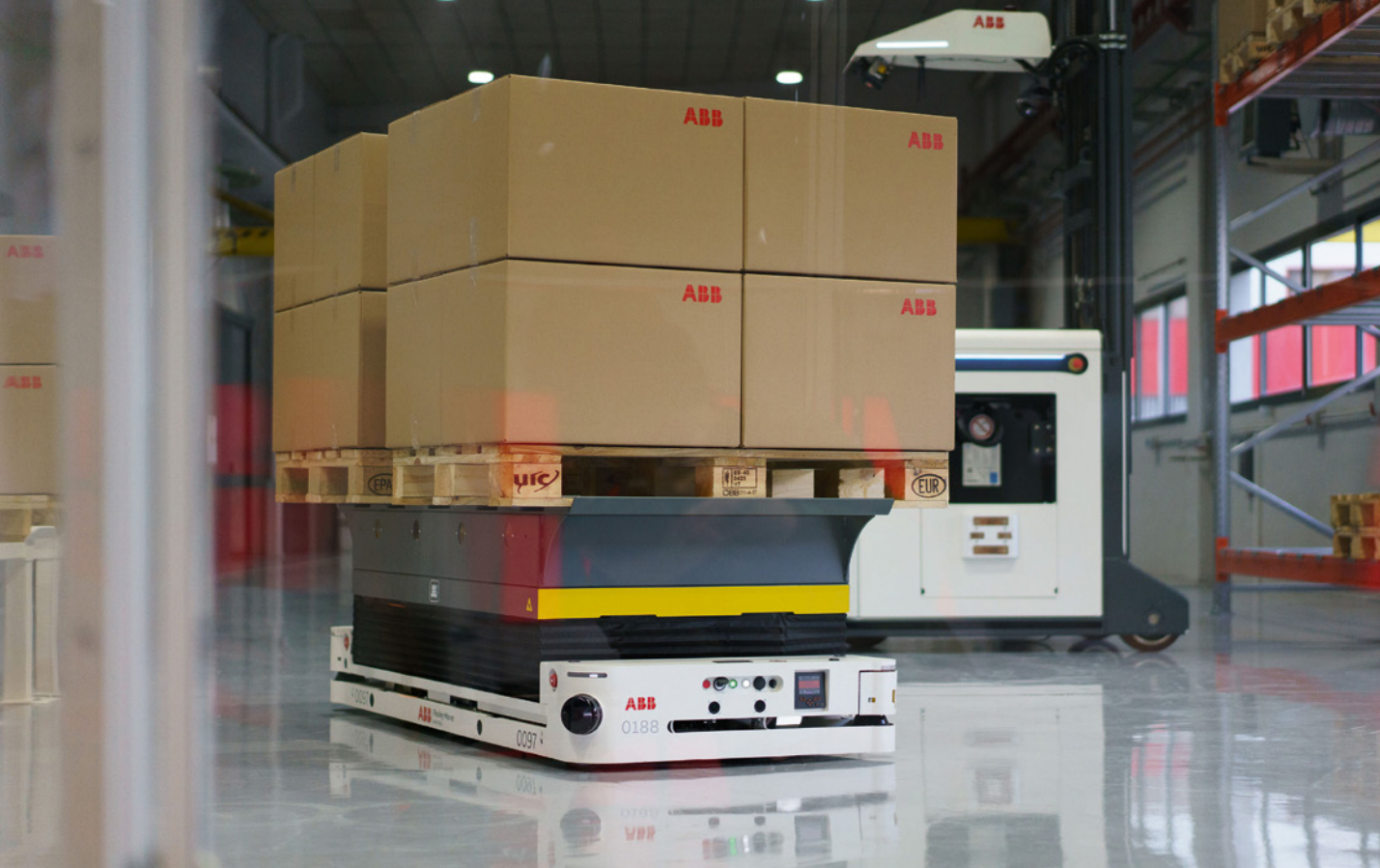
Hohe Präzision und ein sanfter, geräuschloser Antrieb: Autonomer mobiler Roboter von ABB
