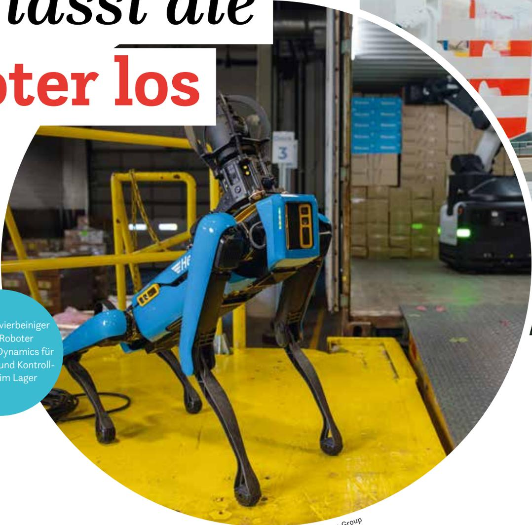
Spot ist ein vierbeiniger mobiler Roboter von Boston Dynamics für Inspektions- und Kontrollarbeiten im Lager
